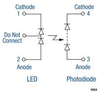
Figure 1. OLI910 Block Diagram
