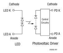
Figure 1. OLI920 Block Diagram
