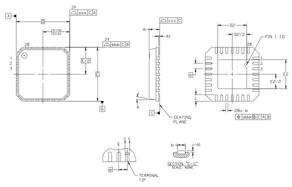
Figure 20. 28-Pin Quad Flat No-Lead (QFN)
