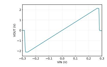
Figure 4.12. Si8920A Typical  $V_{\text{OUT}} \, \text{vs.} \, V_{\text{IN}}$
