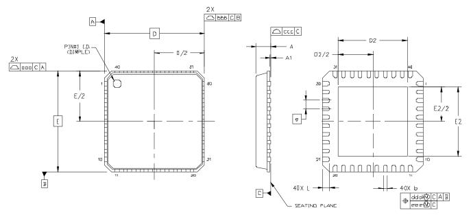
Figure 29. 40-Pin Quad Flat No-Lead (QFN)
