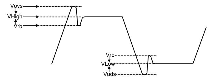
Figure 5. Single-Ended Measurement Points for  $V_{\rm ovs},\,V_{\rm uds},\,V_{\rm rb}$
