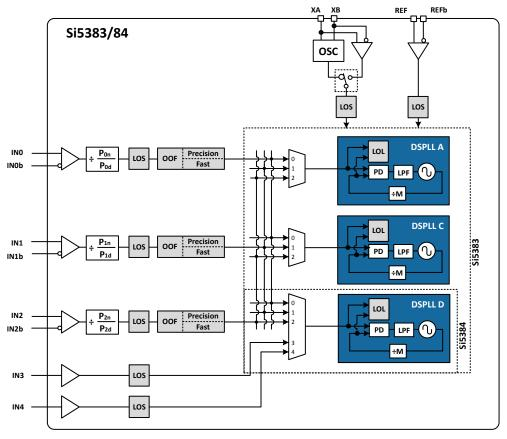
Figure 3.10. Si5383/84 Fault Monitors
